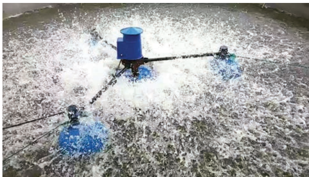
Рис. 3. Современный промышленный импеллерный аэратор для аквакультуры Fig. 3. Modern industrial impeller aerator for aquaculture
